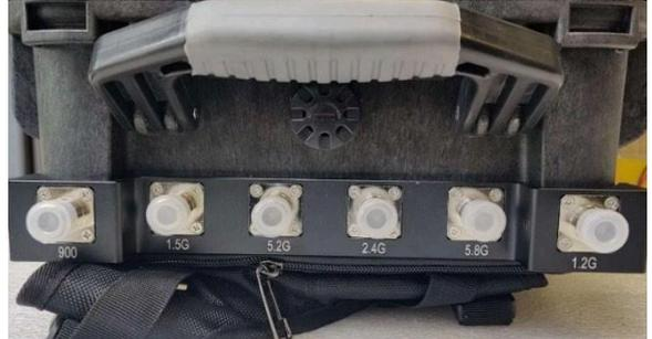
**ВНИМАНИЕ! Не включайте подавитель на передачу без подключенных антенн. Это может привести к повреждению ВЧ модулей и поломке подавителя.**
