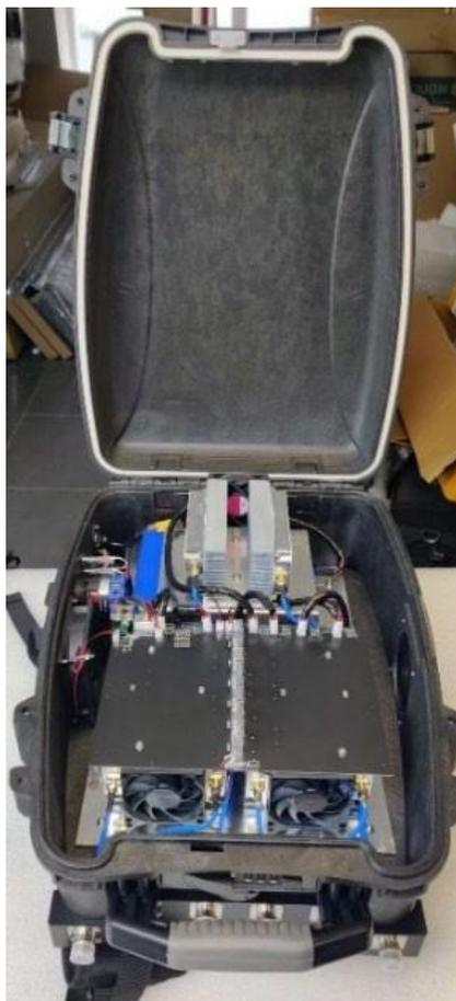
2. Осмотрите вентиляторы, который работает на впуск и выпуск воздуха для охлаждения радиаторов ВЧ модулей. При наличии пыли или грязи удалите её чистой ветошью или продуйте воздухом.
